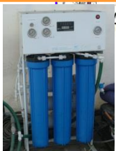
逆浸透膜装置
