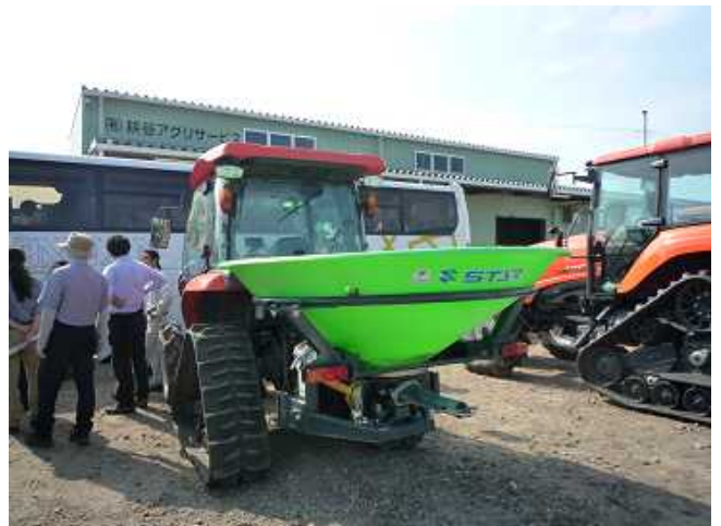
※CANバスを備えたトラクタにより、位置情報、作業機の稼働状態を記録。
