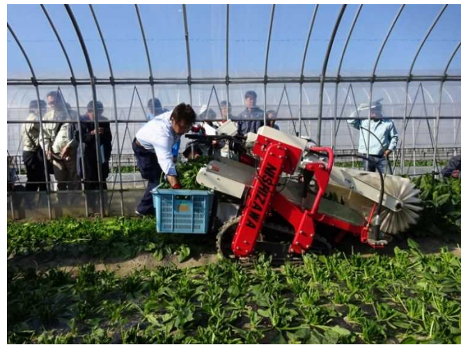
加工野菜収穫機によるホウレンソウ収穫実演
