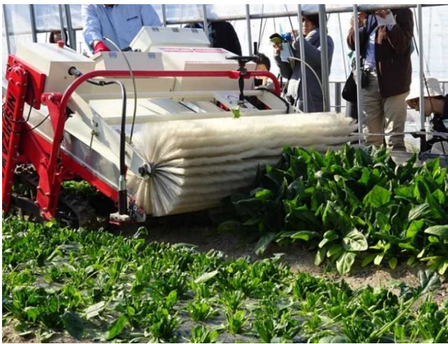
加工野菜収穫機によるホウレンソウ収穫実演
